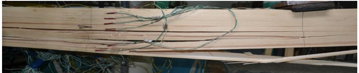
Рис. 4. Характер руйнування дощатоклеєних балок: а) БДК-6; б) БДК-7
