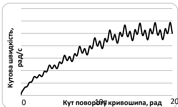
Рисунок 2. Графік зміни кутової швидкості кривошипа установки в залежності від кута його повороту
