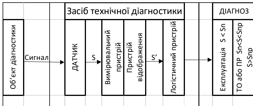
Рисунок 1 - Принципова схема вбудованих засобів діагностування
