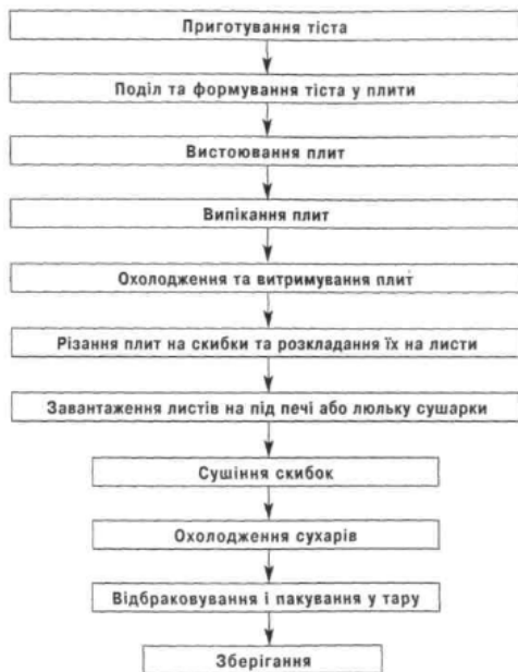
Рисунок 2 - Блок-схема технологічного процесу виробництва здобних сухарів
