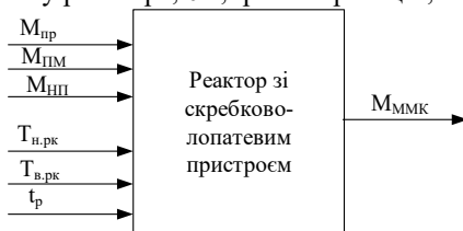
Рисунок 1 – Модель «вхід-вихід» реактора перемішування
