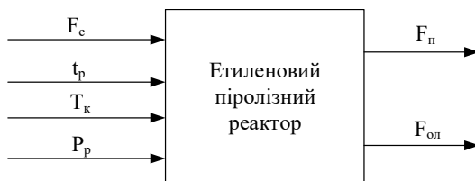
Рисунок 1 – Структурна схема об'єкта керування
